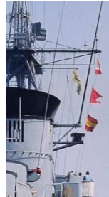
Zwei Antennendome (Bb und Sb) entfernt Querausleger mit Plattformen noch vorhanden Ansicht ab 1968 - 1970 (ÜAG 104/70)
