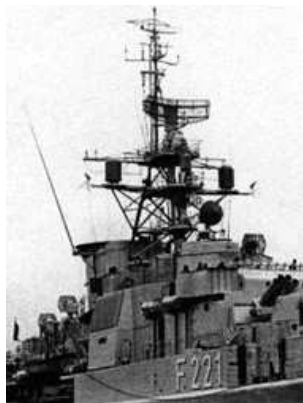
Erstausrüstung der Sensorelektronik, schräge Turbinenansaugschächte, Ansicht von 1961 - 1965
