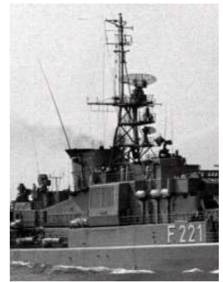
Umgebaute, gerade Turbinenansaugschächte Ansicht ab 1967
