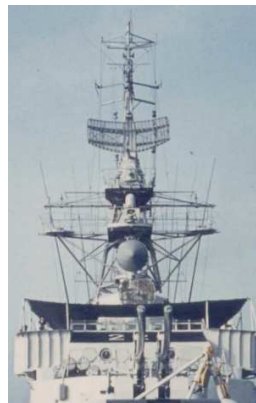
Zwei Antennendome (Bb und Sb) entfernt Querausleger mit Plattformen noch vorhanden Ansicht ab 1968 - 1970 (ÜAG 104/70)
