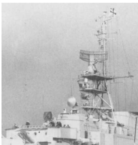
Querausleger mit Plattformen vom Mast entfernt Ansicht ab 1971 - 1978
